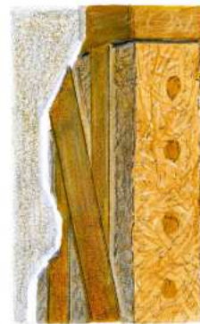
mur en pan de bois et torcbeis enduit à la chaux
