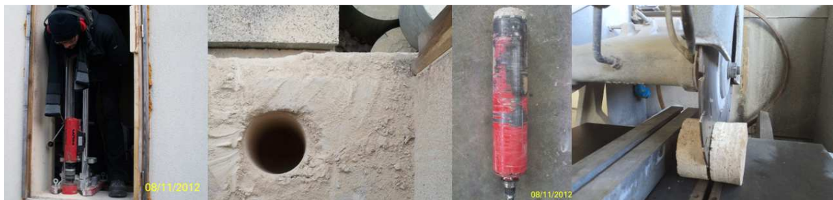
Figure IV-1 : Carottage et découpage des éprouvettes du béton de bois
