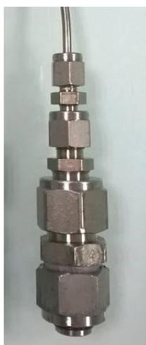
**Figure 46 : Cellule de moussage sans solvant 5 mL**
