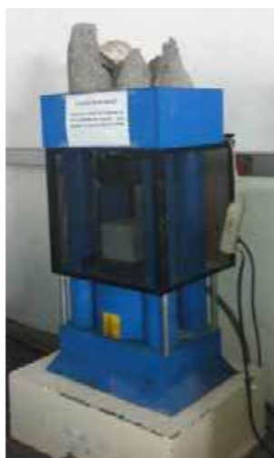
Figure 28- Presse à béton : éprouvettes cylindriques et cubiques
