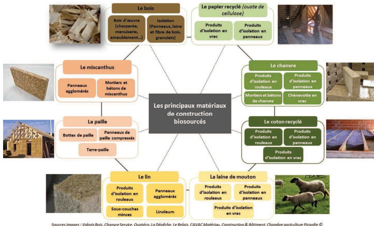
Figure 1. Présentation des principaux matériaux de construction biosourcés
