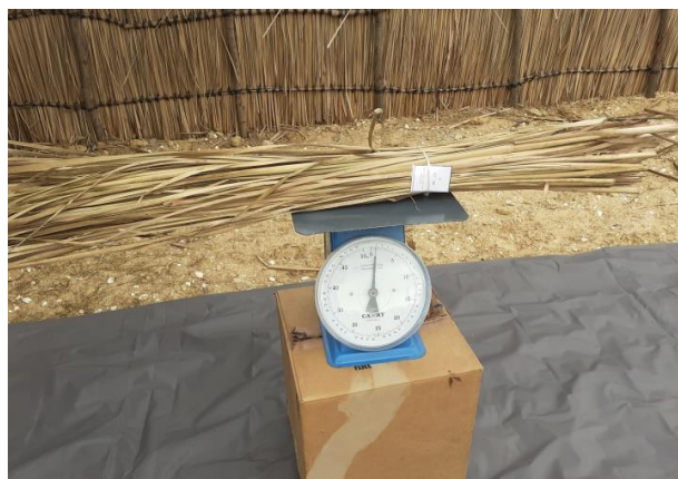
Pesage des échantillons avant et après séchage
