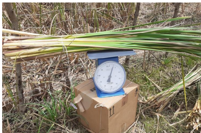
Pesage des échantillons avant et après séchage
